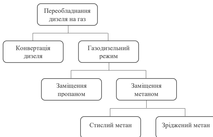
Рис. 4. Способи переобладнання дизельних двигунів на газове паливо
